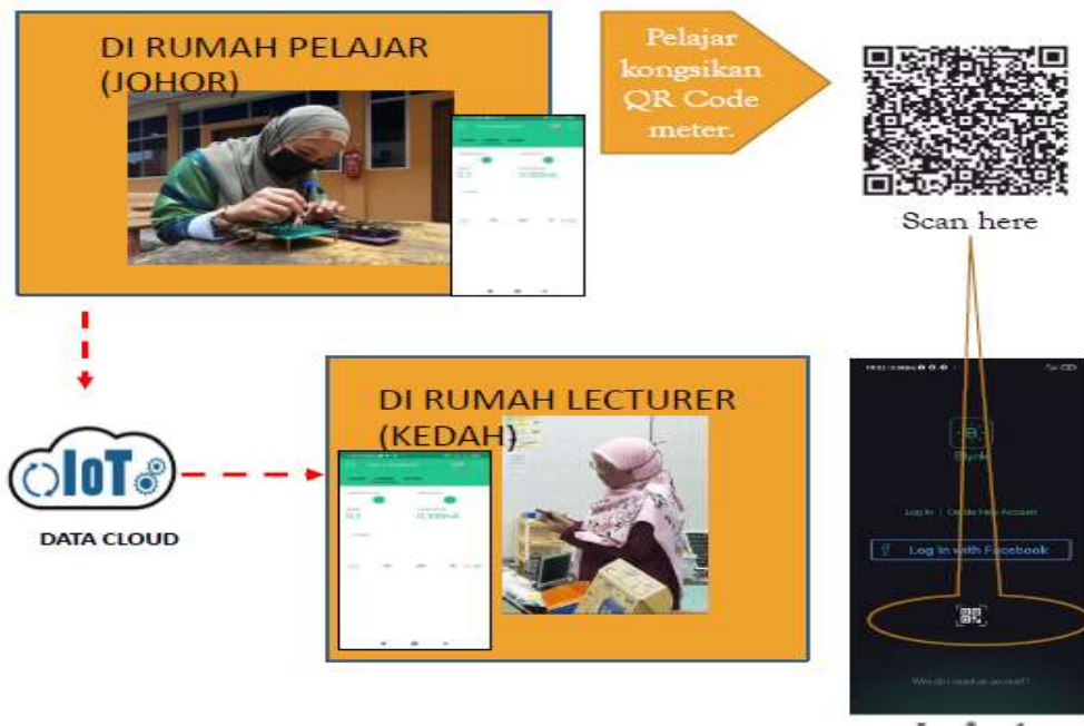
Gambar rajah 10. Proses perkongsian bacaan ukuran secara IoT melalui aplikasi Blynk.
