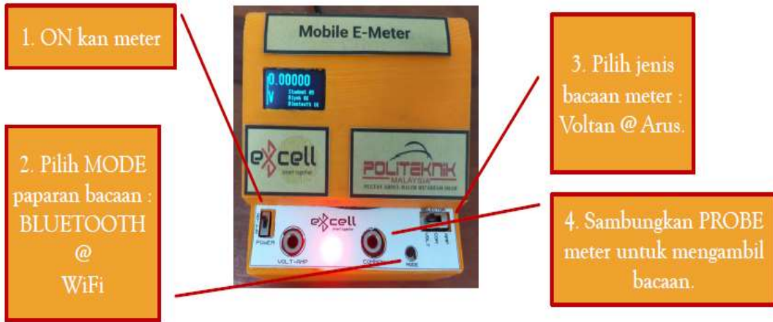
Gambar rajah 9. Proses mengambil ukuran voltan/arus pada Mobile E-Meter .
