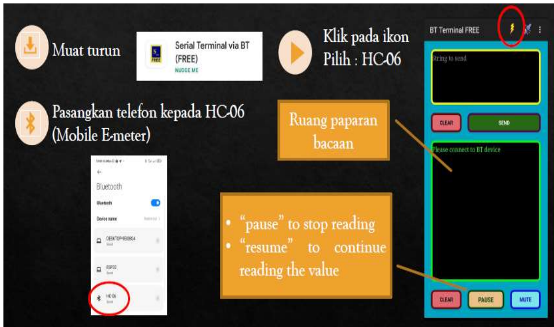
Gambar rajah 11. Proses tetapan paparan secara Bluetooth
